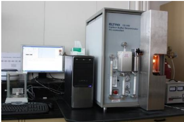
Figure 5: A. Analyseur carbone/soufre Eltra CS800 utilisé à l'Université Laval. B. Protocole de préparation des échantillons pour la mesure du soufre total ( S_T ) des granulats (Rodrigues et al., 2016a,b).
