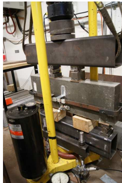
Figure 2 : Montage de fluage flexionnel
