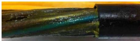
Figure 6. Instrumentation par fibre optique d'un toron gainé graissé
