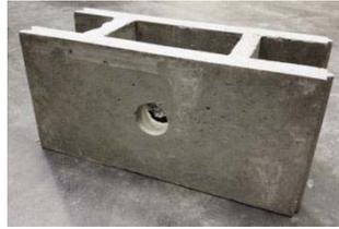
Figure 10 – Réserve de 60 mm de diamètre pour la simulation de futurs passages de gaines techniques.
