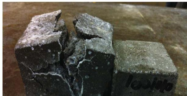
**Figure 4** Bloc de MBE très expansif et bloc de MBE de ciment Portland
