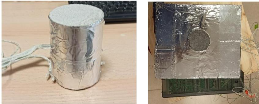
Figure 1. a) Échantillon de mortier couvert latéralement de papier en aluminium, b) Échantillon placé à l'intérieur de la plaque isolante en polyuréthane.
