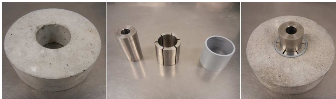
Figure 1 : Schéma de l'éprouvette de mortier et du cœur expansif
